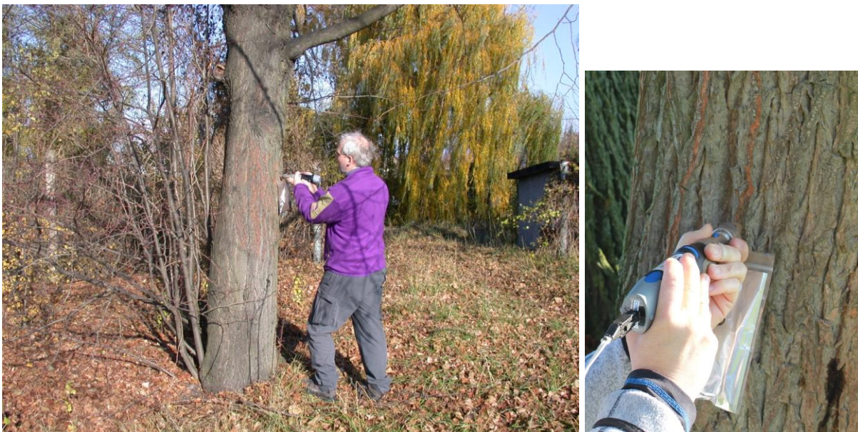
Abb. 2.1: Standardisierte Entnahme der äußeren Rinde zum Luftgüte-Rindenmonitoring mit dem Rindenprobenehmer (Archivbild Hofmann)
